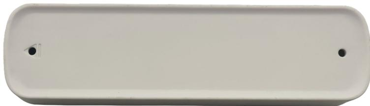
El sensor de viento 3D Win cuenta con un diseño a prueba de agua, con un grado de protección IP65, adecuado para instalaciones al aire libre. Su diseño de bajo consumo hace que sus baterías AAA duren entre 2 y 3 años con un rendimiento óptimo. Cuenta con un regulador de sensibilidad para calibrar la fuerza ejercida por el viento a la cual el sensor mandará recoger el toldo. El sensor se debe instalar en la barra de carga del mismo.
